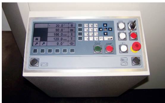
Optional mit 4-Achs-NC-Steuerung für die Einstellung der Schnittwinkel und der Auslinkhöhe und Auslinktiefe
